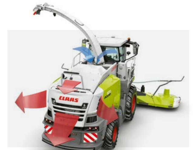
Интегрированный компрессор подает 600 л/мин под давлением 9,5 бар. Воздух может использоваться для управления тормозной системой прицепа и работы инструментов с пневмоприводом, например воздушного пистолета, с помощью которого выполняется обдувка JAGUAR после окончания работы.
