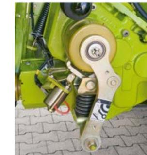
Предохранительная муфта металлодетектора
