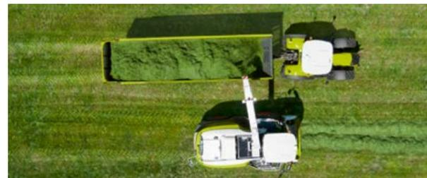
Два запрограммированных положения силосопровода облегчают процесс поворота на краю поля. Кроме того, силосопровод можно автоматически перевести в положение парковки нажатием кнопки.
