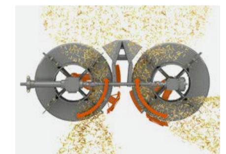
Радиальный распределитель для эффективного распределения соломы при минимальных затратах энергии
