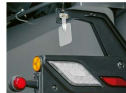
Датчик автомат. регулировки направления разбрасывания
