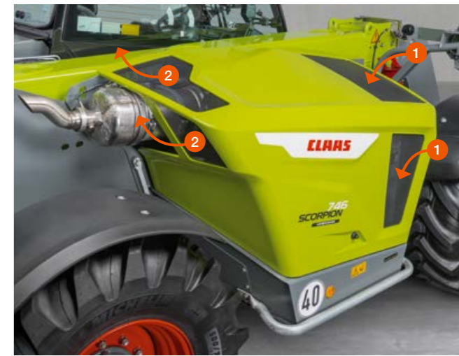
▲ Ilma otetaan edestä, puhtaalta alueelta (1) ja ohjataan taaksepäin (2) ylöspäin suunnattuna. Tämä ei pelota eläimiä ja samalla se vähentää pölyn muodostumista.
