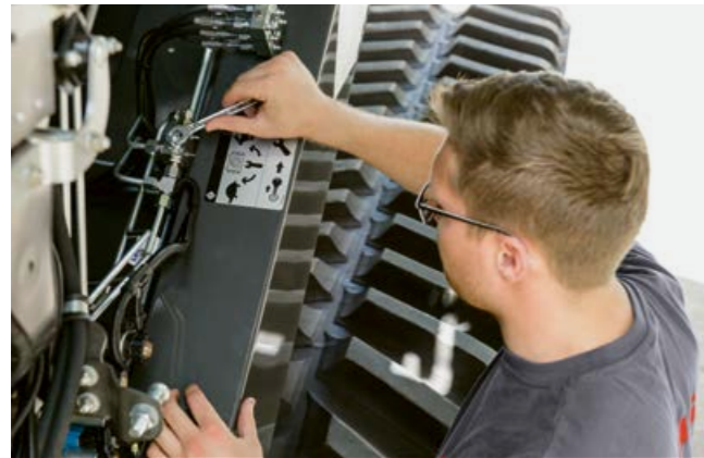
Cele două intervale de turații ale reductorului bătătorului pot fi comutate manual prin intermediul unei supape hidraulice.
