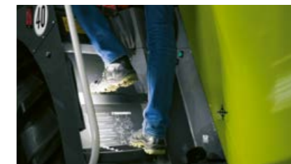
Светодиодная подсветка ступеней обеспечивает безопасный подъем в комфортабельную кабину.
