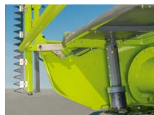
Регулируемые прижимы, опционально также гидравлические.
