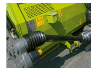
Мощная трансмиссия с трехступенчатым редуктором.
