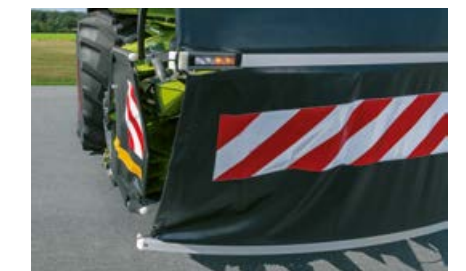
Боковые и передние щитки с предупреждающими наклейками хорошо видны. Светодиодное освещение является полностью встроенным.
