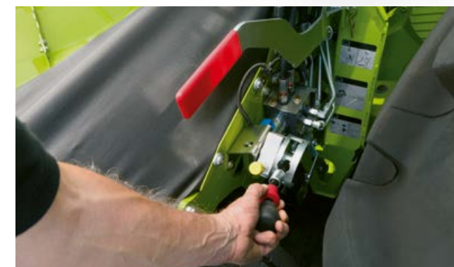
Трехступенчатая регулировка частоты вращения питателей для равномерного потока материала.
