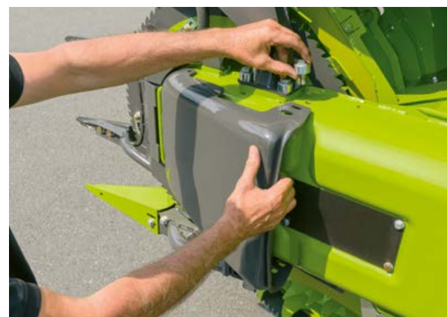
Скользящие башмаки с двухступенчатой регулировкой по высоте.
