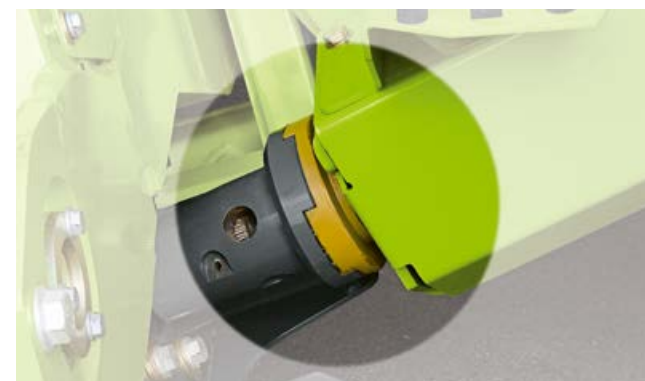
Передача усилия посредством быстроразъемной муфты.
