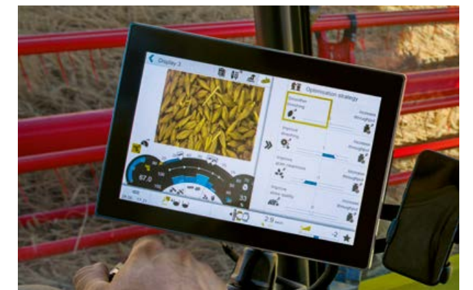
Smart styrning med CEMOS AUTOMATIC via CEBIS.
