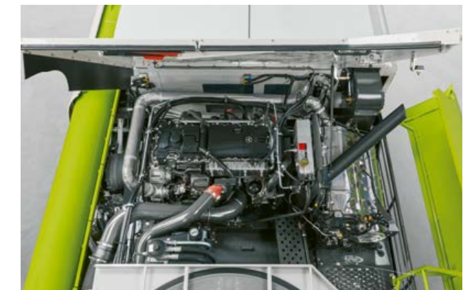
Mercedes-Benz OM 470 – 300 kW / 408 hk för LEXION 6700.
