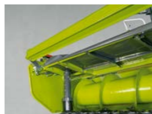
Presă cu rolă pentru o alimentare uniformă cu material recoltat.
