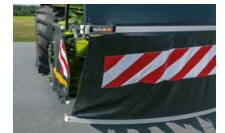
Protecția laterală și frontală sunt vizibile în mod clar datorită autocolantelor de avertizare. Iluminarea LED este complet integrată.
