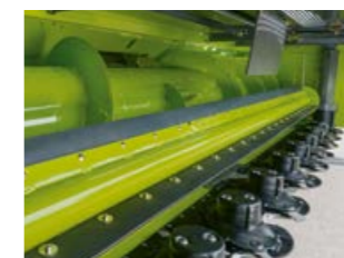
DIRECT DISC 600 P / 500 P cu role prevăzute cu valțuri care pot fi reglate hidraulic în înălțime, opțional.
