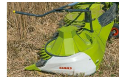
Conul pentru porumb culcat de mari dimensiuni optimizează fluxul de material recoltat și previne depunerea materialului pe discul de transport.
