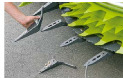
Elementul de ghidare detașabil îmbunătățește ridicarea porumbului culcat.
