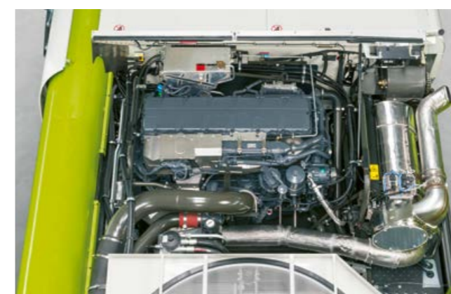
LEXION 8900 avec moteur MAN D42 de 581 kW / 790 ch
