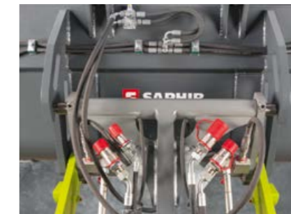
Conduite de retour sans pression et conduite d'huile de fuite supplémentaire branchée sur le tablier à l'avant. (644 / 537)
