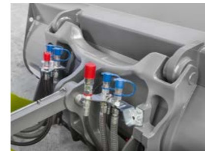
Raccords hydrauliques facilement accessibles et parfaitement protégés sur le tablier. (956)
