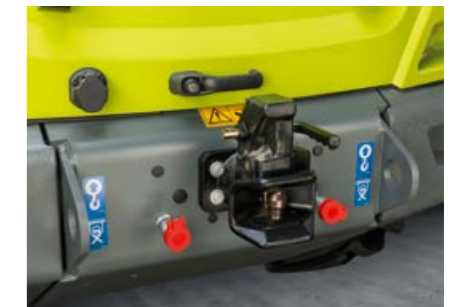
TORION 956 SINUS avec conduite de retour hydraulique sans pression en option à l'arrière.
