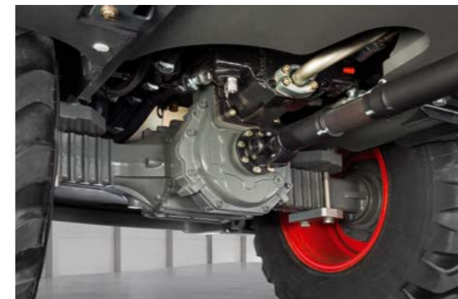
Transmission hydrostatique à freinage autobloquant.
