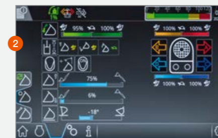
Affichage des valeurs de la limitation des hauteurs de levage et d'abaissement sur l'écran tactile de 9 pouces.
