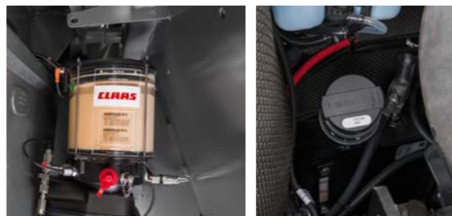
L'orifice de remplissage de l'huile hydraulique est situé sous le capot, dans une zone propre. Le niveau d'huile peut être lu directement à travers un verre-regard bien visible.
