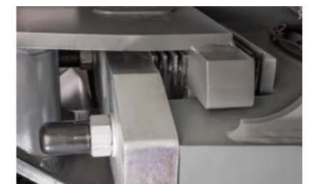
Les amortisseurs en caoutchouc de l'articulation pendulaire centrale améliorent le confort de conduite.
