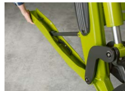
Les béquilles se replient facilement dans le châssis du chargeur frontal pour ne pas gêner la visibilité sur celui-ci.
