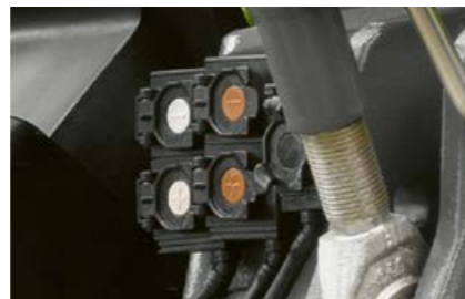
Jusqu'à quatre coupleurs hydrauliques et un retour libre sont disponibles à l'avant avec le relevage avant. Un équipement idéal pour une trémie ou une lame montée sur le relevage avant.
