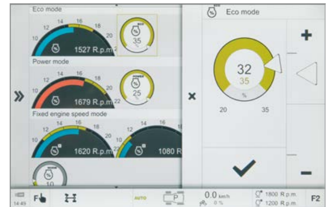
Réglage du régime moteur pour les modes « Eco » et « Power » ainsi que pour la mémoire moteur
