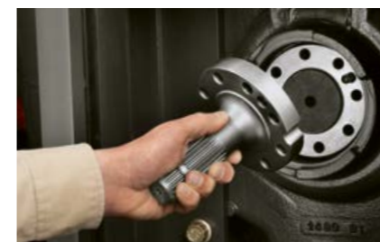
Embout de prise de force facilement interchangeable.
