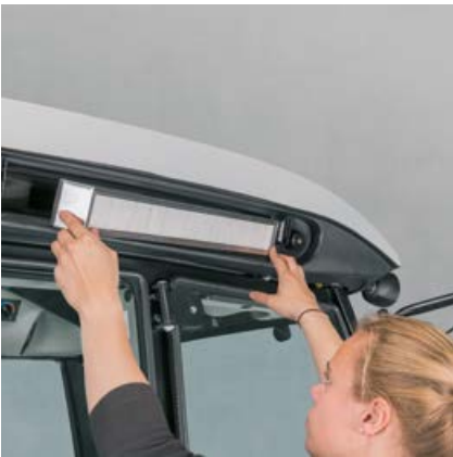
Facilement accessible depuis l'extérieur pour le nettoyage, le filtre à air de la cabine assure la continuité de l'alimentation en air frais de la cabine.
