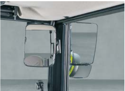
Un rétroviseur grand angle est disponible en plus du large rétroviseur pour une sécurité accrue sur la route.
