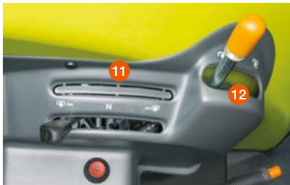
La prise de force est engagée hydrauliquement de série. Sur les tracteurs avec REVERSHIFT, l'automatisme d'engagement et de désengagement de la prise de force est disponible en option.
