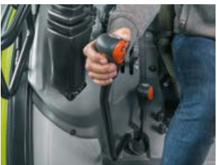
Avec REVERSHIFT : commande de l'embrayage électro-hydraulique par simple pression sur un bouton du levier de commande.
