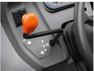
Situé à portée de main à gauche du volant, l'inverseur est commandé au choix de façon mécanique ou électro-hydraulique avec le REVERSHIFT.
