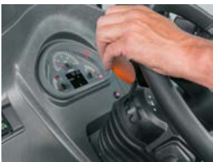
Situé à portée de main à gauche du volant, l'inverseur est commandé au choix de façon mécanique ou électro-hydraulique avec le REVERSHIFT.
