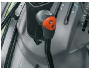
Vous disposez au choix d'un doubleur mécanique à droite du volant ou d'un doubleur sous charge TWINSHIFT qui se commande avec le levier de vitesses.
