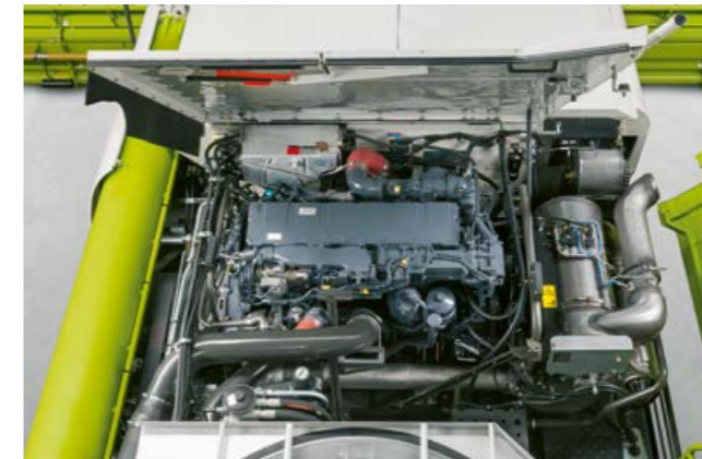
MAN D 26 cu 373 kW / 507 CP pentru LEXION 6900
