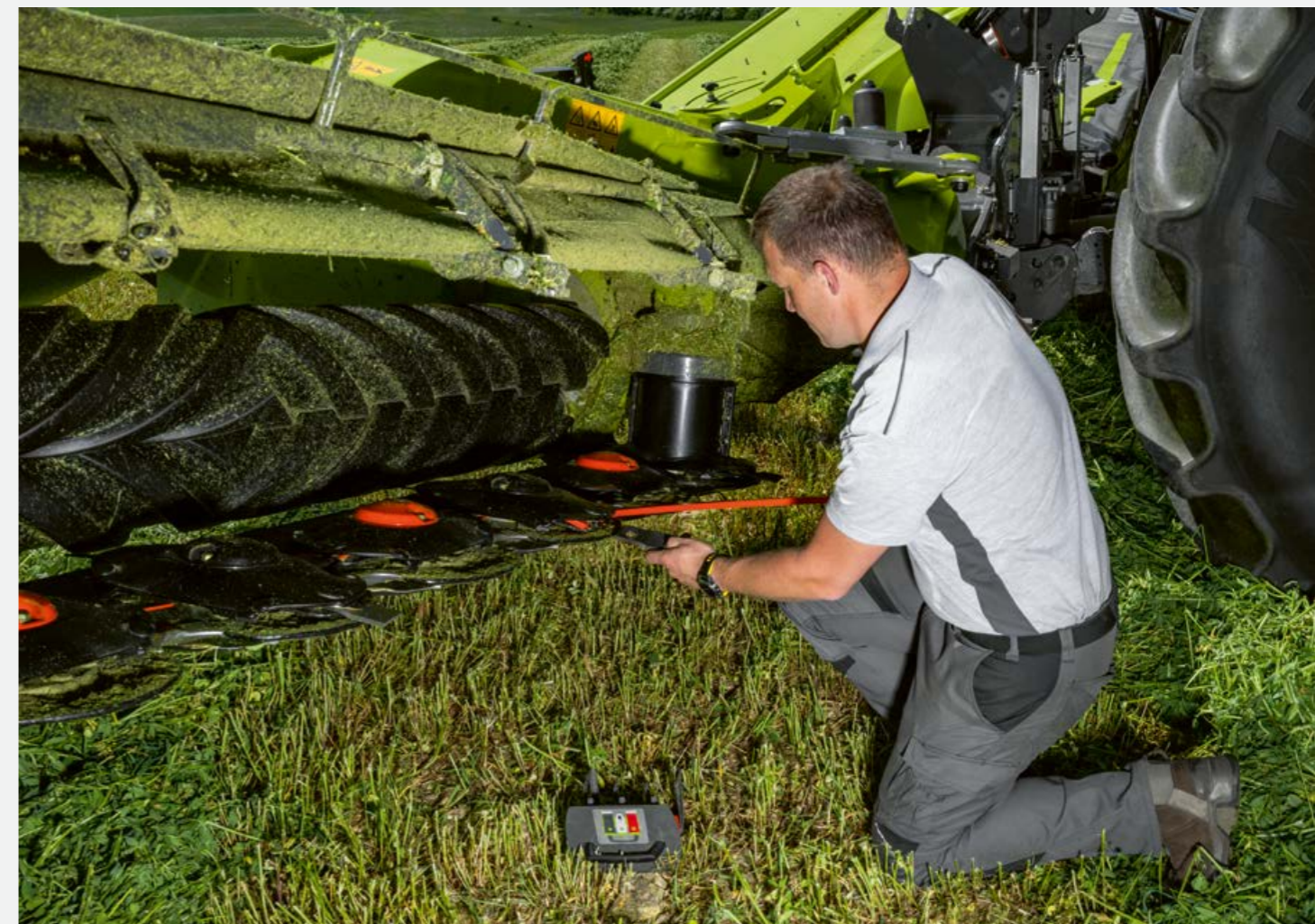
Náhradní nože jsou uloženy ve schránce izolované proti vlhkosti na stroji, což usnadňuje jejich výměnu přímo na poli. Nože lze snadno a rychle vyměnit pomocí montážní páky dodávané se strojem.
