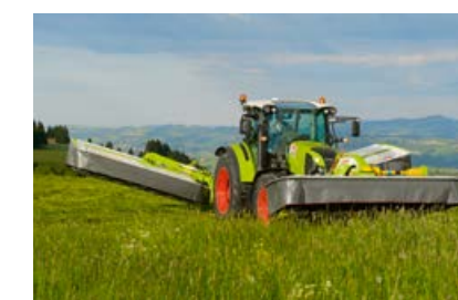
Díky kompaktnímu zavěšení v předních ramenech disponuje žací stroj na souvrati velkou světlou výškou.
