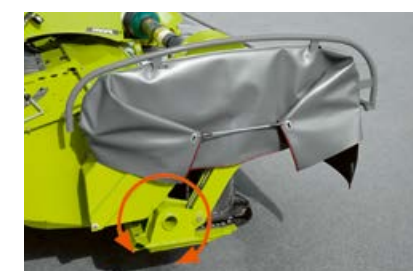
Díky nízkému položenému kyvnému zavěšení kopíruje DISCO PROFIL povrch terénu nezávisle na traktoru.
