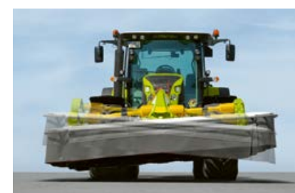
Přizpůsobení příčně ke směru jízdy díky volně se pohybujícímu zavěšení.
