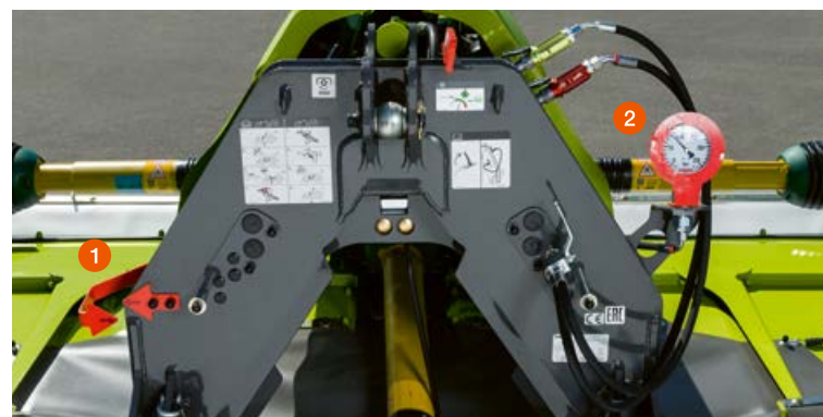
1 nastavení pracovní výšky, 2 manometr ACTIVE FLOAT
