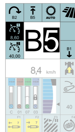
Inteligentna izbira prestave na zaslonu A-stebra variante CIS.
