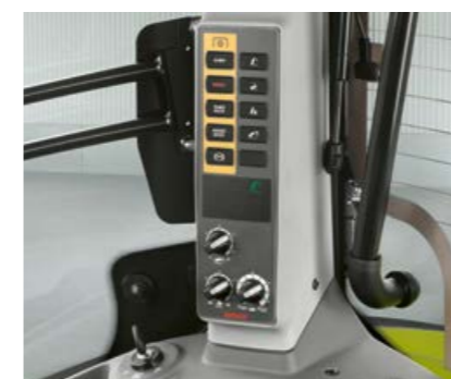
Hitrosti priključne gredi in elektronske regulacije zadnjega hidravličnega dvigala so nastavljive na B-stebru.
