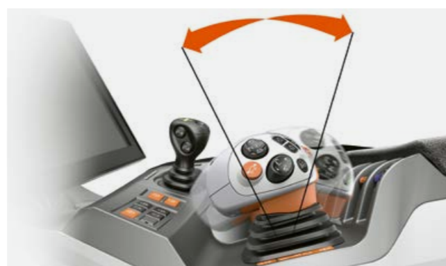
Progressivno upravljanje s tehnologijo brezstopenjskega menjalnika CMATIC.
