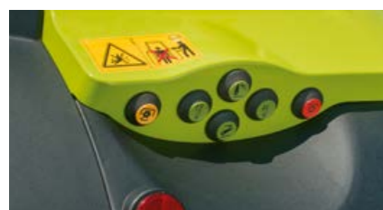
Zunanji upravljalni elementi za zadnje hidravlično dvigalo, priključno gred in izbirni krmilni ventil (samo CEBIS).
