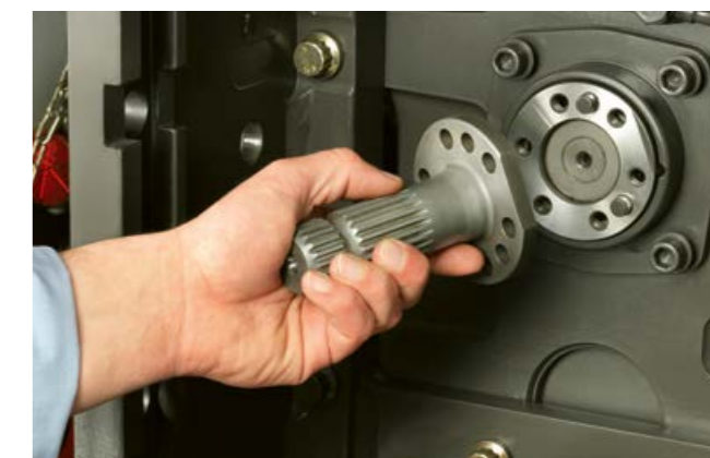
Enostavna zamenjava nastavka priključne gredi.
