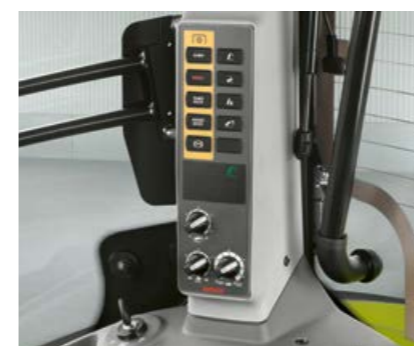
Hitrosti priključne gredi in elektronske regulacije zadnjega hidravličnega dvigala so nastavljive na B-stebri.
