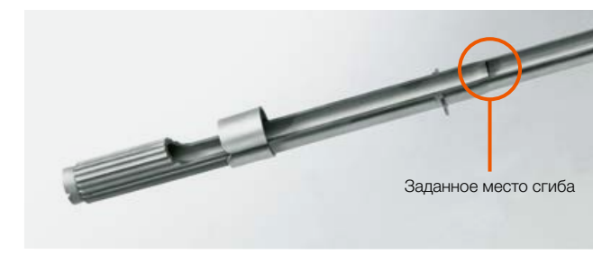
Максимальная защита: в случае столкновения граблины сгибаются в заданной точке излома.
