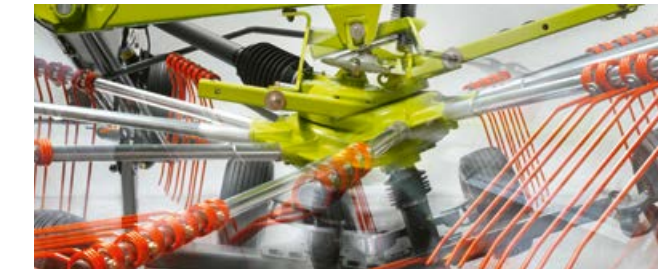
Карданная подвеска роторов: роторы копируют рельеф почвы независимо от трактора.
