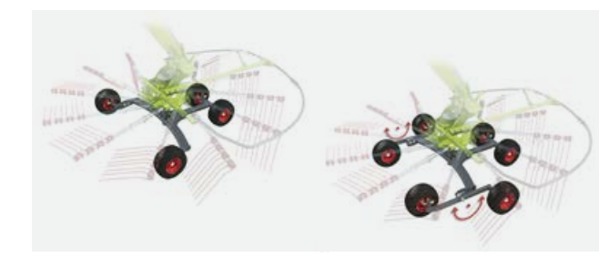
Идеальное управление пальцами: благодаря ходовой части ротора, которая расположена максимально близко к пальцам по периметру.
