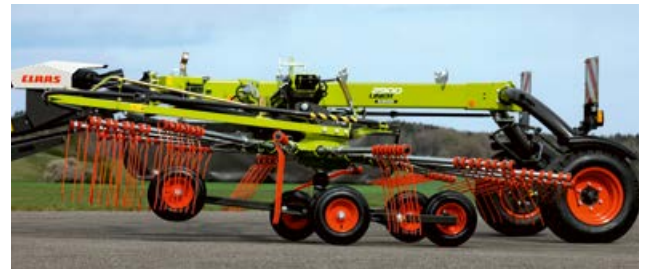
Эффект реактивного самолета: ротор ведет себя при подъеме или опускании, как самолет при взлете или посадке.
