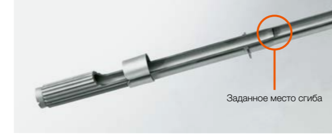
Максимальная защита: в случае столкновения граблины сгибаются в заданной точке излома.
