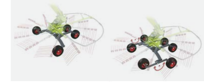
Идеальное управление пальцами: благодаря ходовой части ротора, которая расположена максимально близко к пальцам по периметру.
