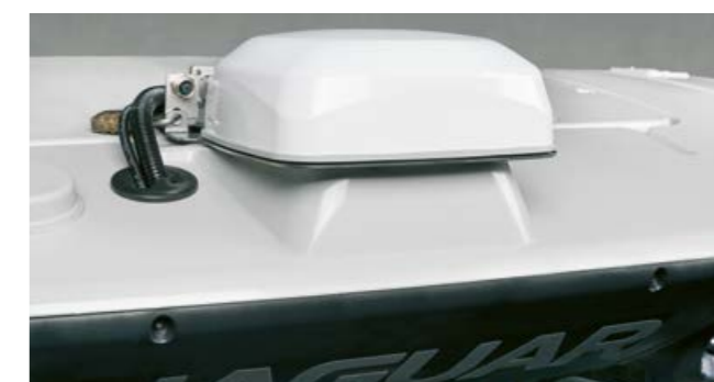
Антенна SAT 900 и приемник в одном — с противоугонным устройством
