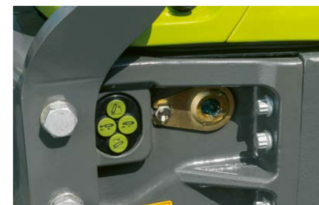
Med elektronisk betjente hydraulikkventiler kan ekstra ventiler og trepunktshydraulikken foran også betjenes utvendig.
