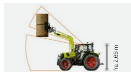
Førerhus med høyt tak og takluke: Gjennomkjøringshøyde fra 2,66 m.
