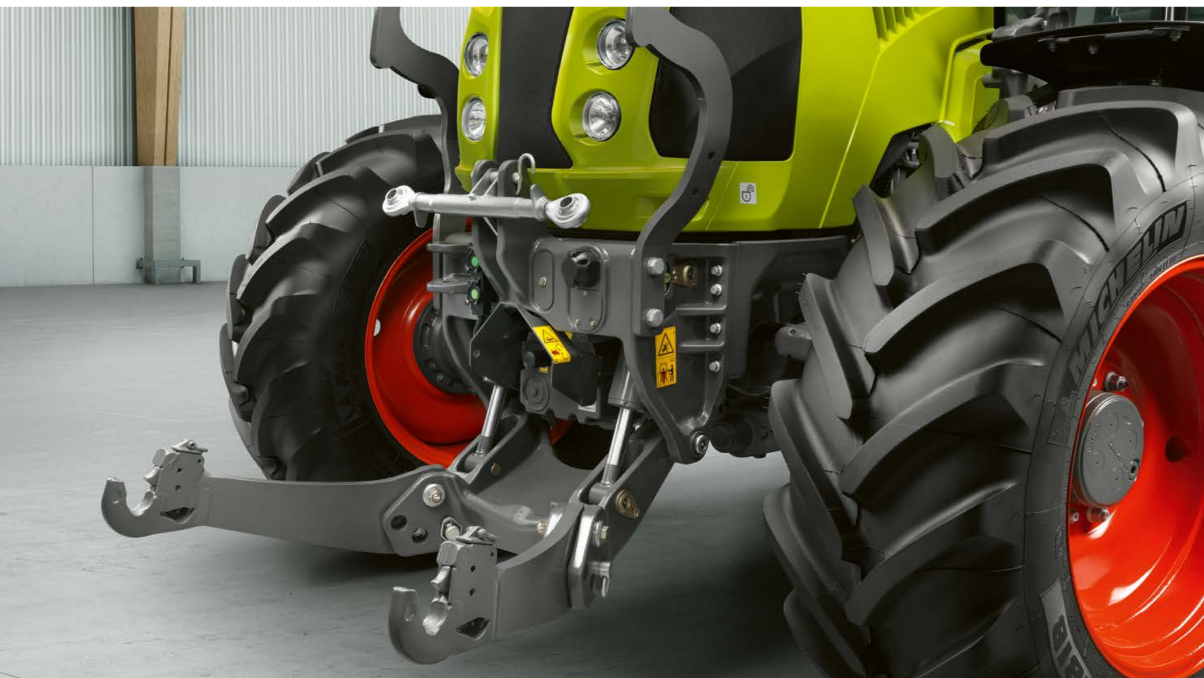
Den sterke trepunktshydraulikken foran gjør traktoren meget allsidig.
