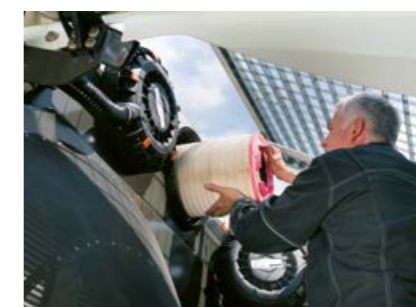
Замена воздушного фильтра без использования инструментов
