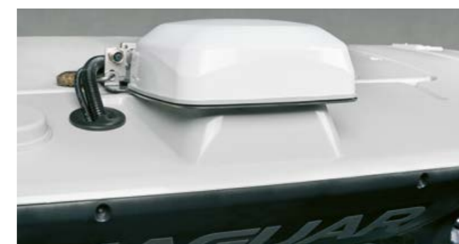
Антенна SAT 900 и приемник в одном — с противобугонным устройством
