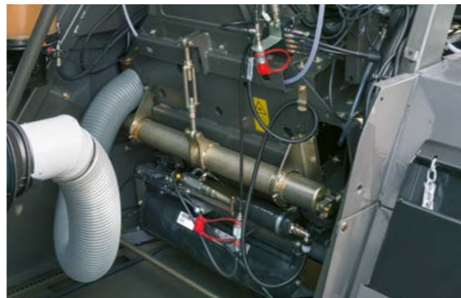
Механическая регулировка зазора выходного ускорителя
