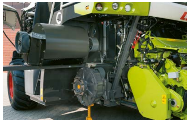
Простой монтаж и демонтаж ускорителя
