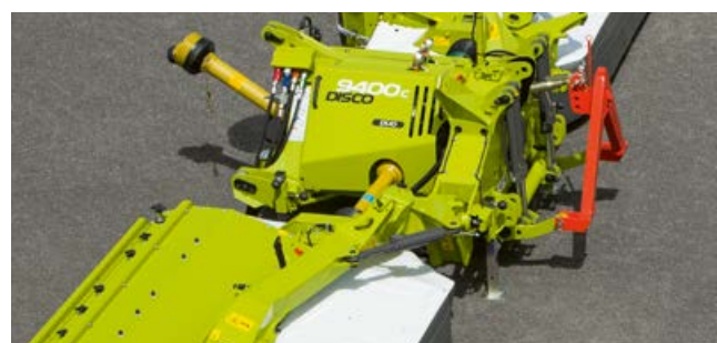
Защита гидравлическим противонаездным устройством непрерывного действия в случае столкновения: косилочный модуль отклоняется и затем самостоятельно возвращается в исходное положение.
