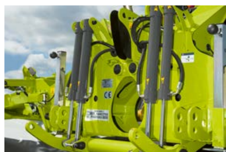
Входящие в стандартное оснащение цилиндры подъема и разгрузки ACTIVE FLOAT обеспечивают снижение нагрузки на дерновой слой.
