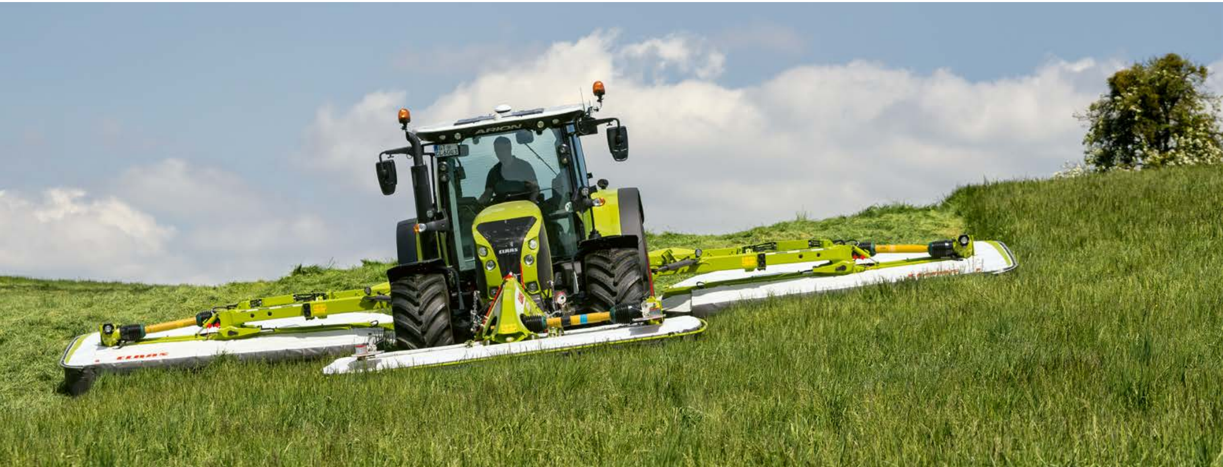
Для DISCO 1100 TREND предусмотрен удобный блок управления для раздельного подъема, складывания в транспортное положение и опционально для включения и выключения фар рабочего освещения.
