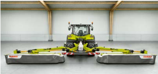
Две телескопические стрелы с гидравлическим управлением с бесступенчатой настройкой для оптимального перекрытия в DISCO 1100 TREND.
