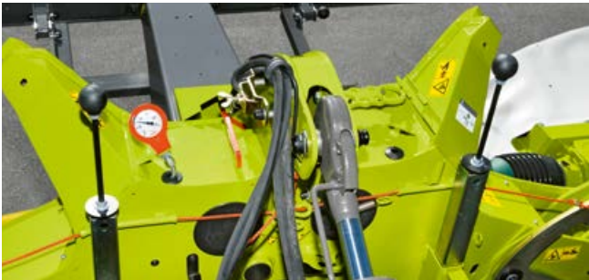
Манометр для простой регулировки давления разгрузки обоих косилочных модулей.
