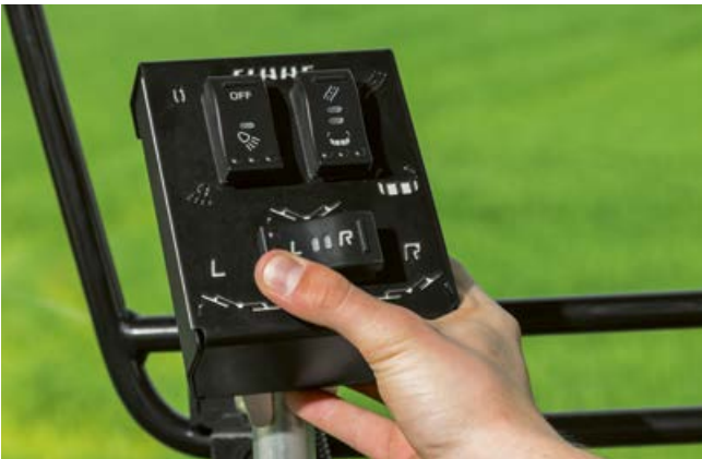
Для DISCO 1100 TREND предусмотрен удобный блок управления для раздельного подъема, складывания в транспортное положение и опционально для включения и выключения фар рабочего освещения.
