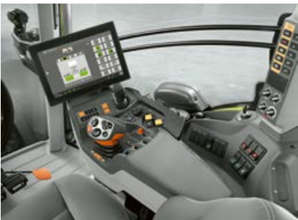
Если трактор оснащен ISOBUS-совместимым терминалом, с его помощью можно осуществлять прямое управление CONTOUR с предварительной установкой.
