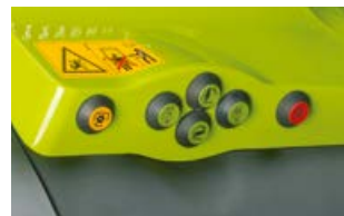
Utvendig betjening av trepunktshydraulikken bak, kraftuttaket og en valgbar hydraulikkventil (gjelder kun CEBIS)
