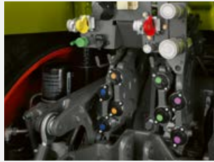
Trykkluftbremseanlegg med lufttørker
