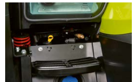
Det er en trykkluttkobling til venstre i innstigningen.
