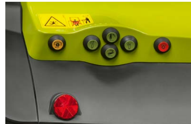
Utvendig betjening av kraftuttaket bak
