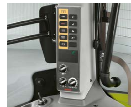
Kraftuttakshastighet og elektronisk løftekraftregulering kan betjenes på B-stolpen.
