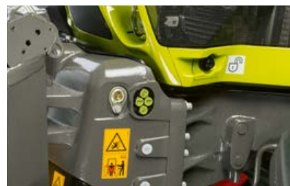
Utvendig betjening av trepunktshydraulikken foran og én hydraulikkventil (modellavhengig)
