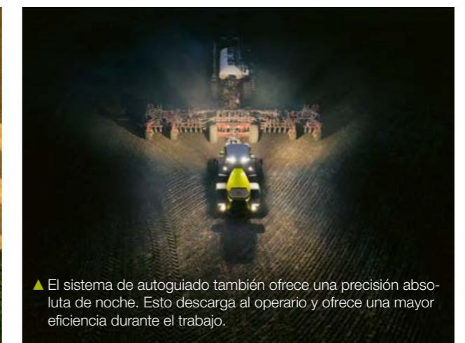
▲ AXION 800 trabajo del suelo. Equipamiento digital: GPS PILOT CEMIS 1200 en modo de contorno A-B y CEMOS.
