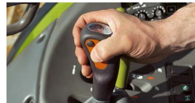
Vier Lastschaltstufen ersparen Ihnen in vielen Fällen den Gruppenwechsel.
