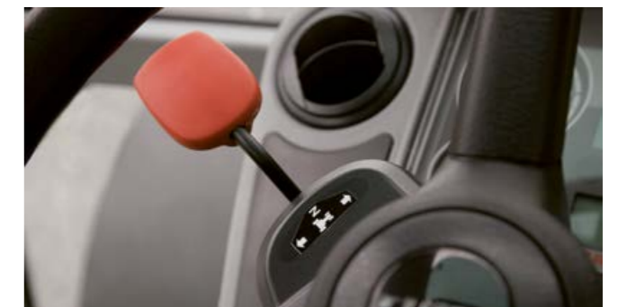
Das Wendegetriebe REVERSHIFT betätigen Sie nur mit den Fingerspitzen.
