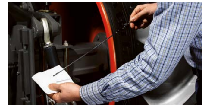
Die Getriebeölstandkontrolle erfolgt einfach am Heck.
