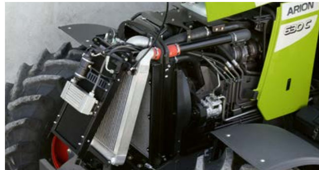
Die Kühler können zur Reinigung schnell weggeschwenkt werden.
