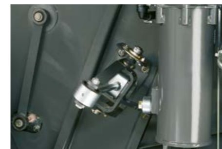
Det helautomatiske 3D-rensesystemet kombinerer hydraulikk og mekanikk, og trenger ikke elektroniske sensorer.
