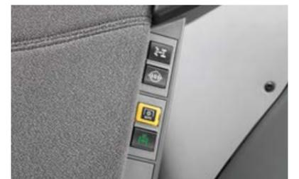
Activation de la suspension du pont avant.
