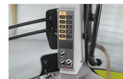
Présélection des régimes de prise de force et relevage arrière électronique installés sur le montant arrière droit de la cabine.
