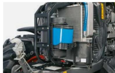
Accessibilité optimale du filtre à air moteur placé devant les radiateurs.
