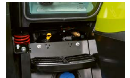
НОВО: вляво в стъпалата се намира щуцер за подаване на състен въздух.
