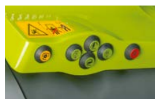
Външни уреди за управление на задна навесна система, силоотводен вал и управляващ уред по избор (само CEBIS).
