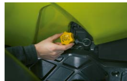
Възможност за контрол на нивото на маслото и допълване при затворен капак.
