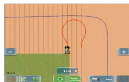
С AUTO TURN тракторът автоматично завива в края на браздата.
