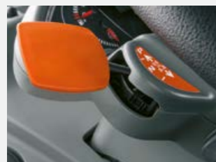
Лостът за реверсиращия механизъм REVERSHIFT се предлага с електронна паркинг спирачка
