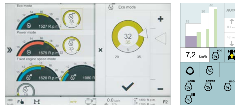
Настройка на натоварването на двигателя за „Eco“ и „Power“, както и на запаметяването на оборотите на двигателя
