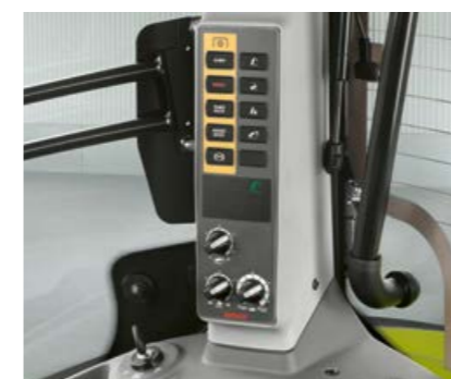
Скорости на силоотводния вал и електронно регулиране на задната навесна система с настройка от средния отсек
