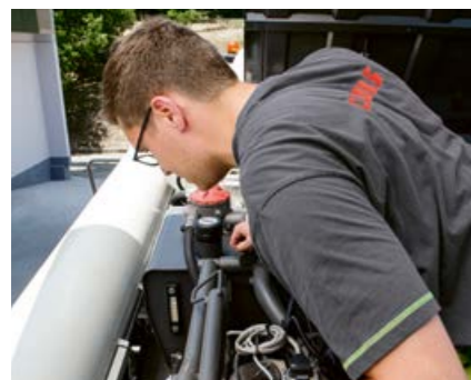
Enkel visuell kontroll av alle oljenivå.
