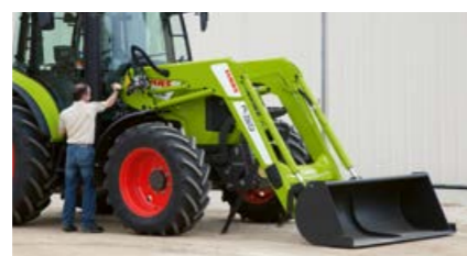
Только один выход из кабины благодаря быстродействующей сцепке MACH и системе FITLOCK.
