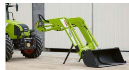
Фронтальный погрузчик CLAAS надежно подсоединен к рабочему инструменту и поддерживается опорными стойками.
