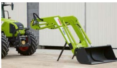
Фронтальный погрузчик CLAAS надежно подсоединен к рабочему орудию и поддерживается опорными стойками.
