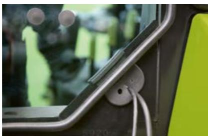
Кабелепровод на заднем стекле допускает использование различных диаметров почти для всех проводов.
