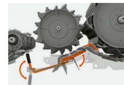
Заслонки предварительной деки удаляют ости и шелуху с зерна.
