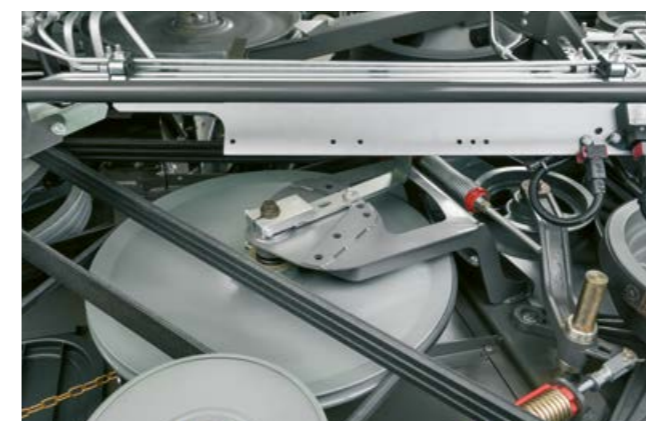
Глубину врезания пальцев в слой соломы можно настраивать.
