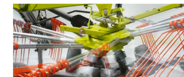
Bevegelig rotoroppheng: Rotorene tilpasser seg bakken – uavhengig av traktoren.
