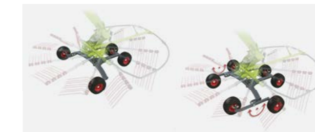
Idell tndforing: Dette sikres av hjulunderstellet under rotoren, som er plassert så nært som mulig til tindene.
