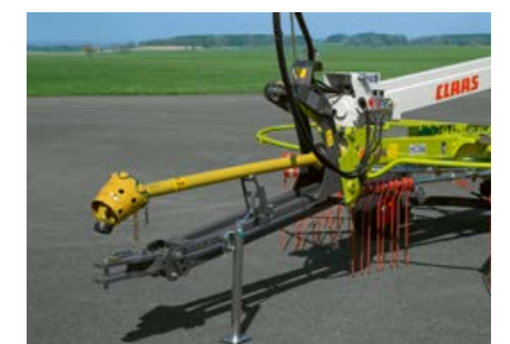
Parallelogramdrag er standard på LINER 800 TWIN og kan leveres som tillegg utstyr på LINER 700 TWIN.
