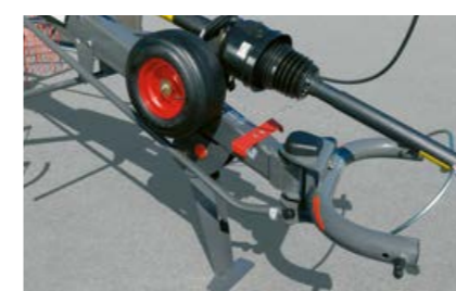
Det fleksible U-rammeoppheget med tverrgående pendling tillater svingmanøvrer ned til 80°.
