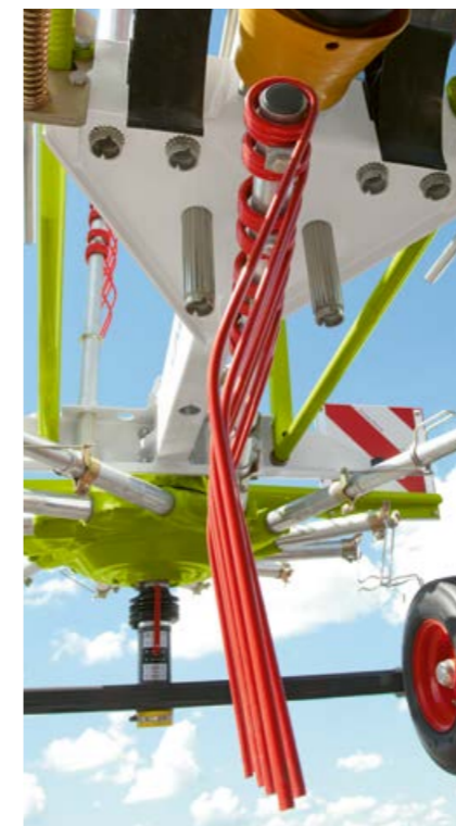
Standardtindene på modellene 450, 420 og 370 er med 9,00 mm tykkelse ekstremt stabile og egner seg for både høy og surfjør.
