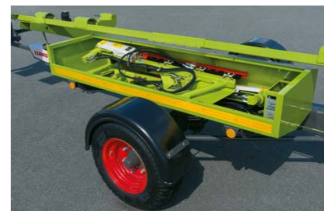
Abschließbare Transportbox für die Rapsausrüstung.
