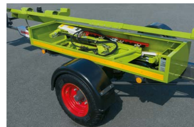
Запирающийся ящик для транспортировки оборудования для уборки рапса.
