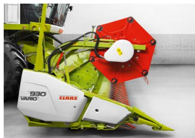
Стол жатки задвинут – уборка зерновых (-100 мм).
