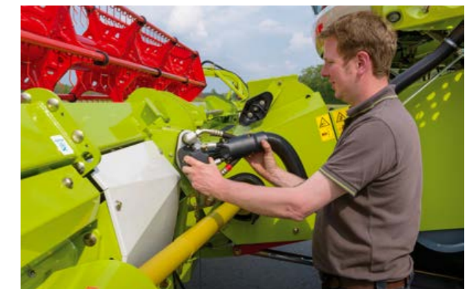
Удобство благодаря многофункциональному разъему и центральной блокировке.
