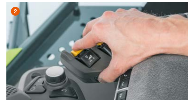
Реверсирование с помощью SMOTION (1) или посредством одновременного нажатия тумблера и кнопки реверсирования (2)
