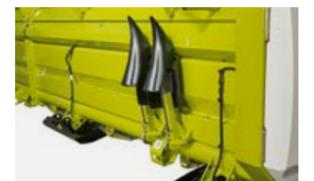
Posición de enganche en el mecanismo de corte para la punta del divisor de mies durante el transporte.
