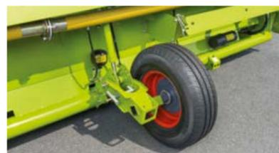
Ruedas estabilizadoras llevan el mecanismo de corte suavemente en todas las condiciones.
