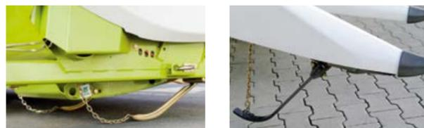
Estribos palpadores determinan la posición del cabezal para AUTO CONTOUR y CONTOUR.
