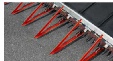
Los levantadores de mies se pueden cambiar rápidamente y sin herramientas.
