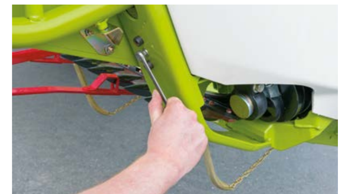
Sencillo reglaje de la altura del divisor de mies con la llave de las tapas.
