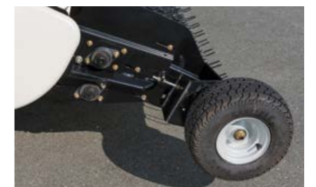
Ruedas palpadoras se encargan de limitar la profundidad.
