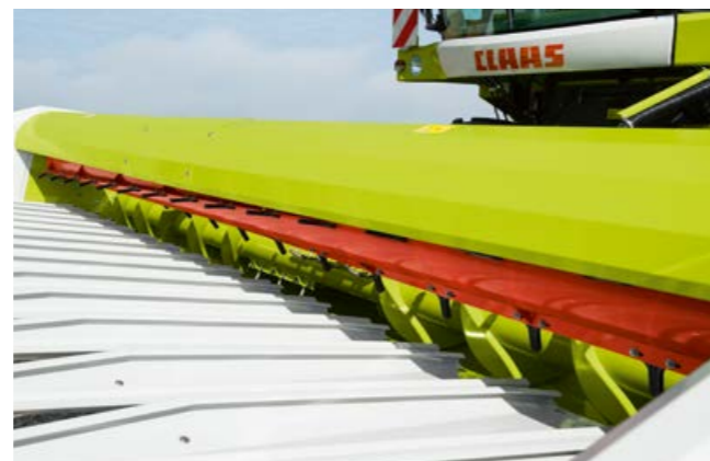
Molinete y sinfín de alimentación
