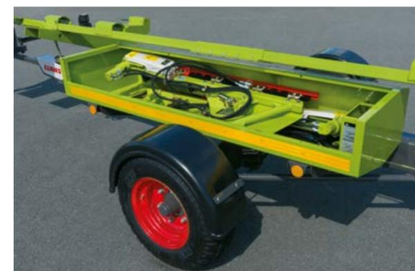
Box di trasporto con serratura per l'equipaggiamento colza.
