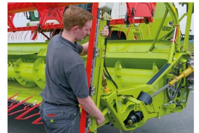
Montaggio delle lame da colza con il sistema di attacco rapido.
