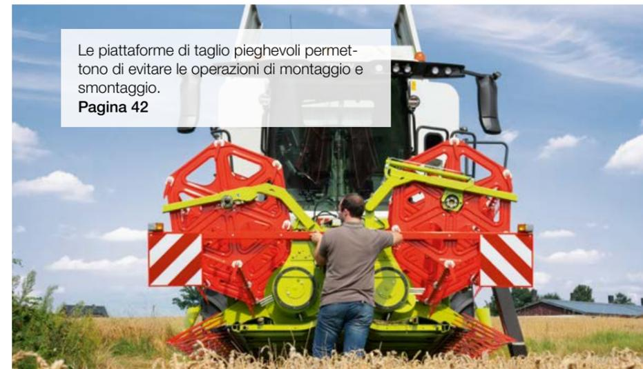
Le piattaforme di taglio pieghevoli permettono di evitare le operazioni di montaggio e smontaggio.
