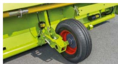
Ruote di stabilizzazione guidano regolarmente la piattaforma di taglio in qualsiasi condizione.
