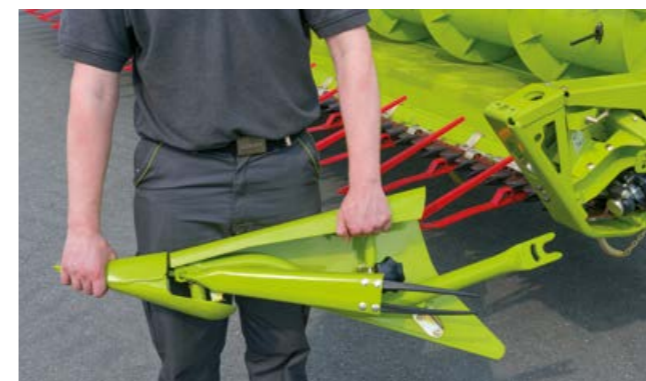
Înlocuire rapidă și simplă a despicătorilor de lan.
