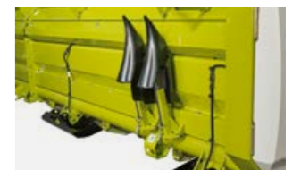
Poziție de depozitare în timpul transportului a despicătorilor de lan.
