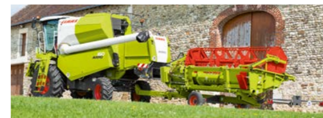
Cărucioarele pentru echipamente frontale asigură transportul rapid și ușor, chiar și între câmpuri aflate la distanță.
