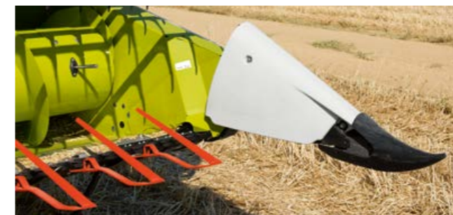
Despicătorii de lan speciali pentru soia se pot deplasa în sus.
