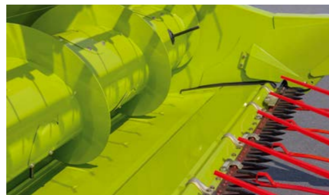
Platformă de tăiere extinsă - boabe (+ 100 mm).
