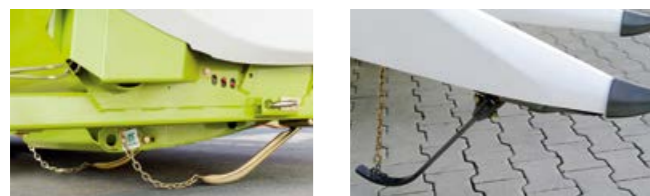
Etrierii de palpare detectează poziția echipamentului frontal pentru sistemele AUTO CONTOUR și CONTOUR.
