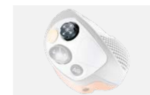
Przestawianie stołu VARIO, belki kosy MAXFLEX i prędkości taśm transportowych CONVIO na wielofunkcyjnym uchwycie CMOTION.
