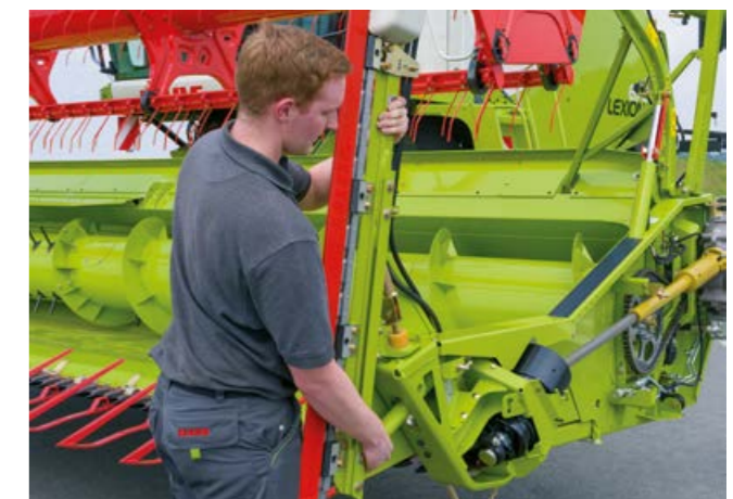
Montaż kosy do rzepaku poprzez szybkozłącza.
