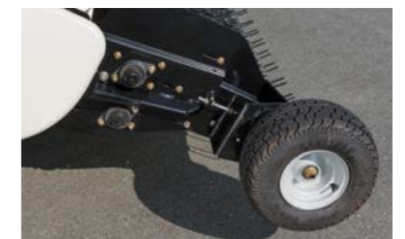
Koła kopiujące ograniczają głębokość.
