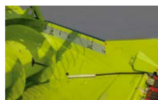
Wskazania pozycji stołu przyrządu roboczego są doskonale widoczne z kabiny.
