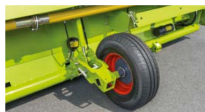
Koła stabilizujące prowadzą przyrząd żniwny spokojnie w każdych warunkach.
