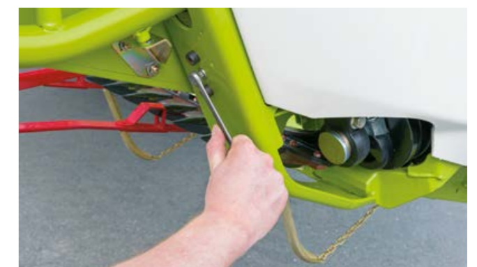
Łatwa zmiana wysokości rozdzielczy łanu składanym kluczem.
