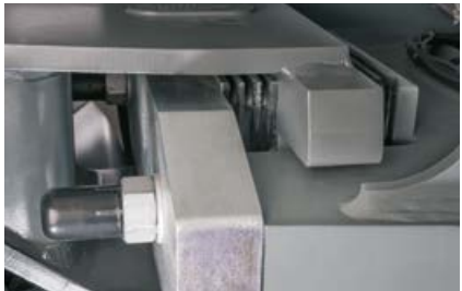
Gummidämpfer im Knickpendelgelenk erhöhen den Arbeitskomfort.
