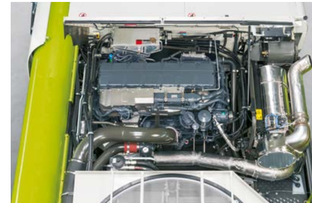
MAN D42 mit 581 kW / 790 PS für LEXION 8900
