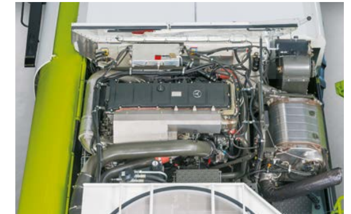
Mercedes Benz OM 473 mit 460 kW / 626 PS für LEXION 8700
