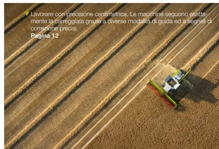
▼ Lavorare con precisione centimetrica. Le macchine seguono esattamente la carreggiata grazie a diverse modalità di guida ed a segnali di correzione precisi.
