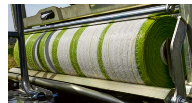
Den nye nettbindingen på VARIANT 500-serien er plassert 25 cm dypere for å enkelt kunne rengjøre nettrullen under nettbremsen.
