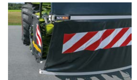
Les bâches latérales et avant sont bien visibles grâce aux autocollants d'avertissement. L'éclairage à LED est entièrement intégré.
