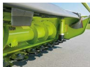
DIRECT DISC 600/500 с консольным шнеком большого размера.
