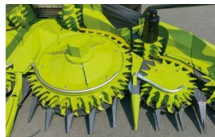
Безопасная транспортировка растительной массы через специальные каналы.
