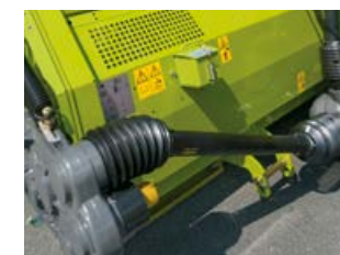
Мощная трансмиссия с трехступенчатым редуктором.
