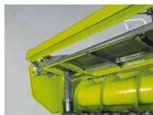
Роликовые прижимы для очень равномерной подачи растительной массы.
