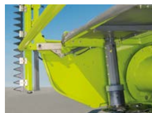
Регулируемые прижимы, опционально также гидравлические.
