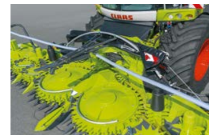
Компактная укладка с неограниченным обзором ORBIS во время уборки. Устройство защиты от повреждений при транспортировке надежно закреплено на машине.
