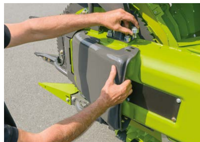
Скользящие башмаки с двухступенчатой регулировкой по высоте.
