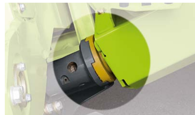
Передача усилия посредством быстроразъемной муфты.
